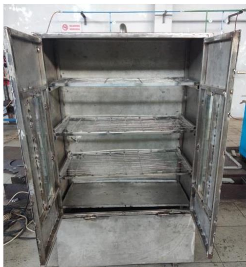
Gambar 8 konstruksi oven pengasap ikan menggunakan bahan bakar kayu
