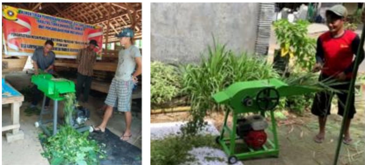
Gambar 5. Uji coba mesin pencacah pakan ternak untuk mencacah rerumputan
